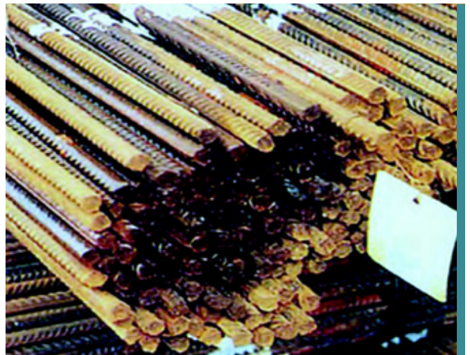
水濡れの痕跡がある鉄筋の束 Clause：錆の付着、船積み前の水濡れ
