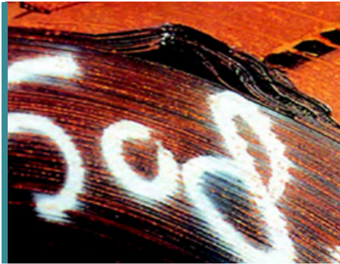
フォークリフトにより損傷したコイル Clause：荷役装置の跡が付いて外周の端部が潰れている。6つのコイルが損傷。
