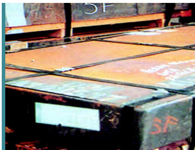
梱包されているスチール板 Clause：部分的な錆の付着
