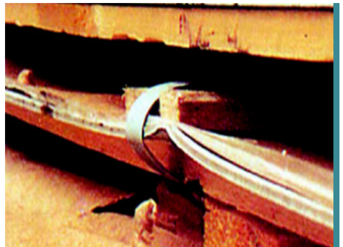
ステンレススチールプレートの束 Clause：荷役装置の跡が付いて中心がへこんでいる。2つのプレートが損傷。
