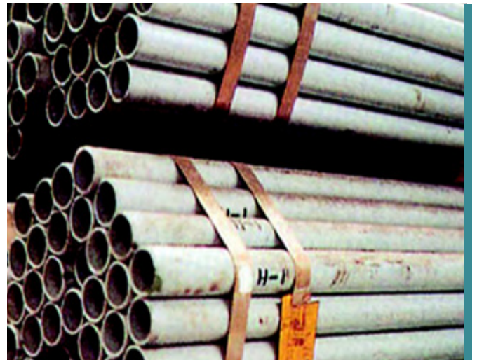
溝形鋼 表面保護の処理の形跡がない垂鉛メッキパイプ管の束 Clause : 垂鉛メッキ処理の不良
