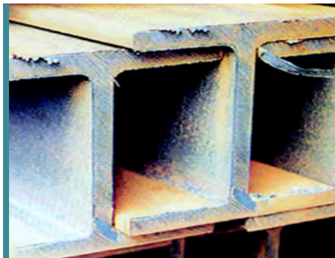
ミルスケールは残っているがフランジとウェブに錆が蔓延るH鋼（正しい置き場所に注意） Clause：錆の付着
