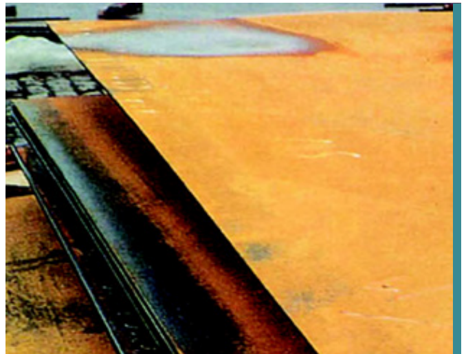
スチールプレート Clause：錆の付着、船積み前の水濡れ
