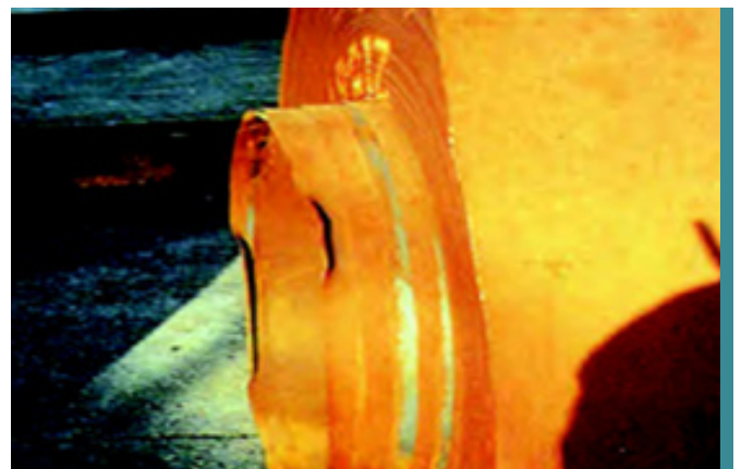
望遠鏡のように突出したコイル Clause：中心部分は150mmまで突出。
